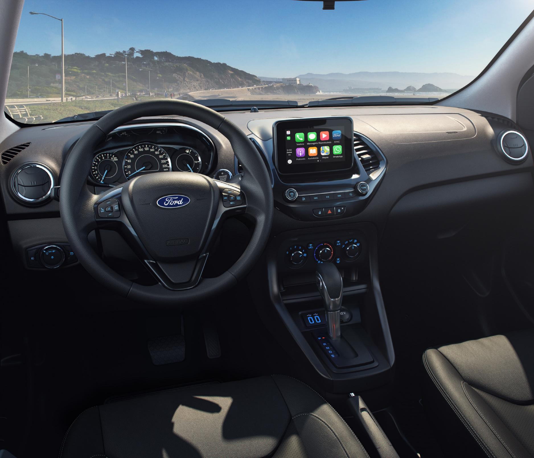
acontecer por meio da movimentação da alavanca (para os lados ou para frente e para trás), do acionamento de teclas ou ainda por meio de borboletas no volante. Seja diante da necessidade de mais força nas subidas, seja para usar o freio-motor em descidas, deve-se usar o controle manual para selecionar a marcha desejada.
